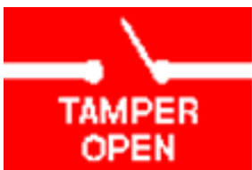
Visas när sabotageskruven på botten av enheten är öppen och menyerna inte går att nå. Detta meddelande visas även i slutet av aktiveringssekvensen. Detektorn går in i menyläget efter att aktiveringssekvensen är klar.
